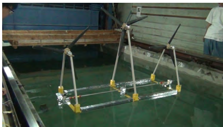
図 7: 1つの浮体に多数機の風車を搭載した新形式浮体式風車
