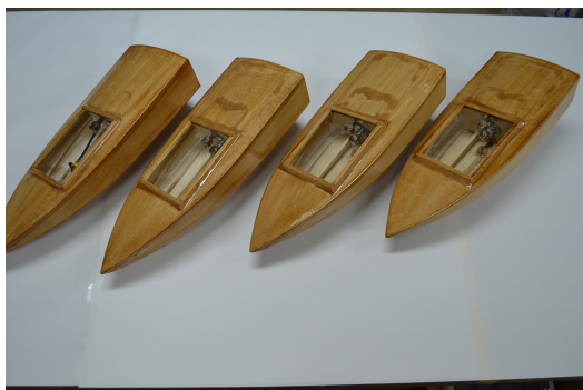
(a) 船体はバルサ材を組み合わせて製作
