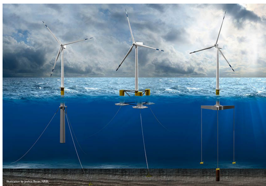
図 2.5: 浮体式風車の浮体形式 [14]
